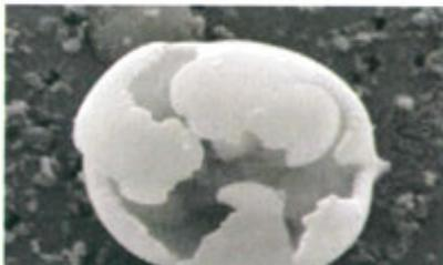
Metallische Abriebpartikel: 1 µm
