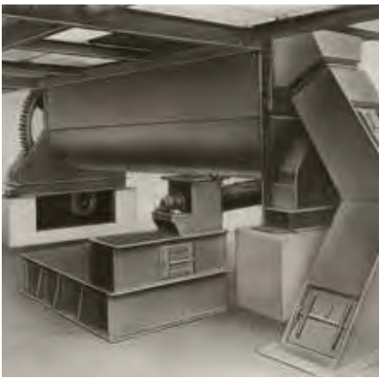
Löschtrog · Slaking trough
